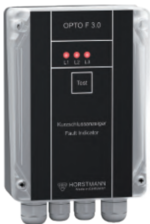
Opto F 3.0, корпус для поверхностного монтажа
