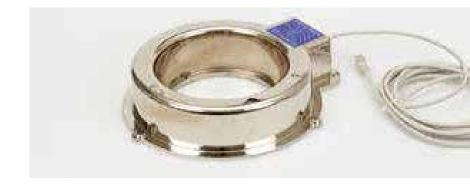
Защитное реле с питанием от трансфорсматора тока занимает миниимальное пространство, но имеет высокую эффективность цифрокого защитного устройства. У него простая, но надежная проводка и высокую электромагнитную помехоустойчивость.
