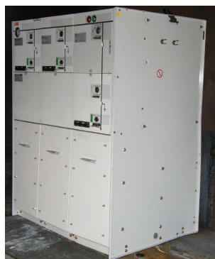
После испытания на дугу с ликвидатором электрической дуги
