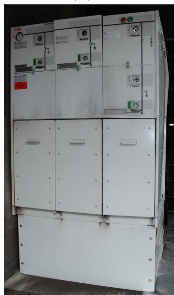
После испытания на дугу без ликвидатора электрической дуги
