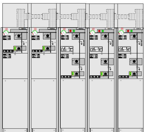
Полностью модульная конструкция SafePlus с крышкой для внешних шин
